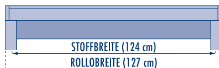
KASSETTENROLLO MIT SEITENFÜHRUNGSSCHIENEN
